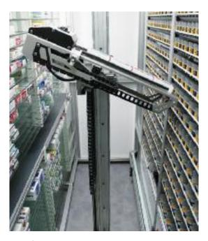
Le préhenseur Multi Picking du RG2 Ultra assure le chargement des canaux de la partie automate. Il vérifie le stock des canaux grâce à un système de télémétrie laser.
